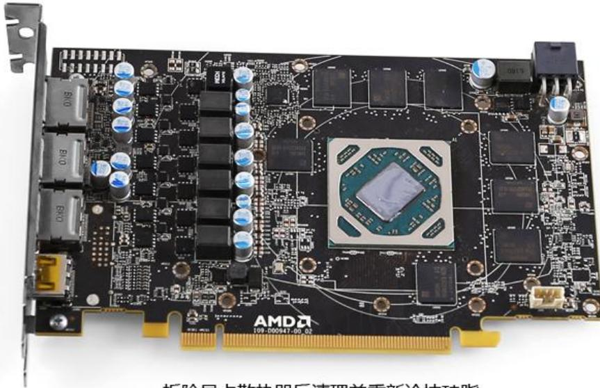
拆除显卡散热器后清理并重新涂抹硅脂
