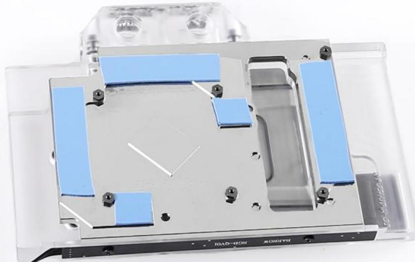
在相应位置贴好导热硅脂，注意剪切尺寸
