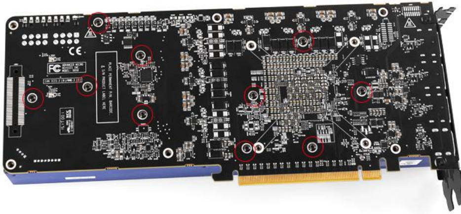
3. 拆除图中标红螺丝
