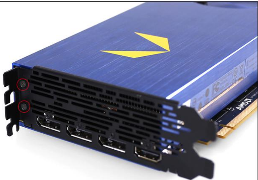
2. 拆除图中标红螺丝
