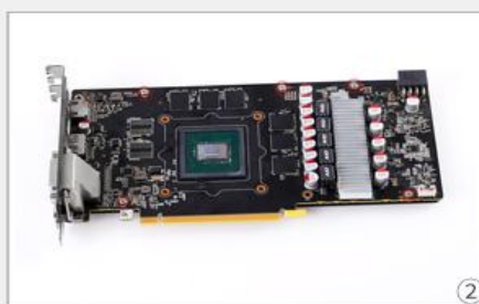
拆除图中标红螺丝
