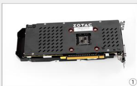
拆除图中标红螺丝
