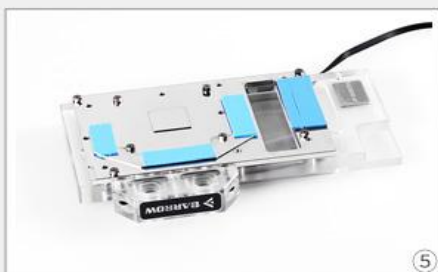
贴好导热硅脂条，注意尺寸
